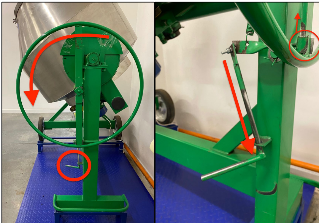
Механизмы опрокидывания (слева) и фиксации (справа)
